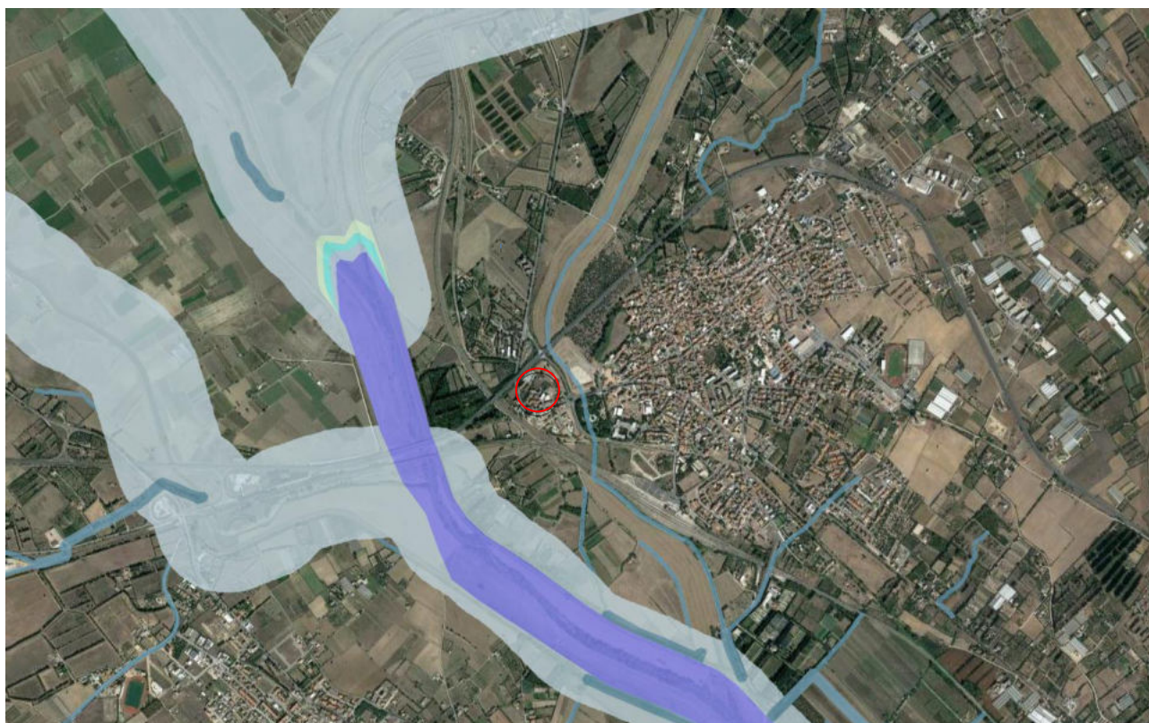
Figura 10: Aree a rischio idraulico, mappatura PAI – il cerchio rosso indica l'area di interesse.
