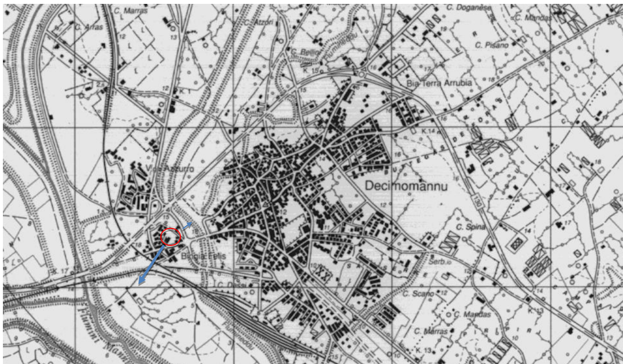
Figura 15: stralcio carta IGM Foglio 556 SEZ. 1 - Decimomannu, con indicazione delle linee di scorrimento dei corsi d'acqua e la localizzazione (con il perimetro in rosso) dell'area di intervento.
