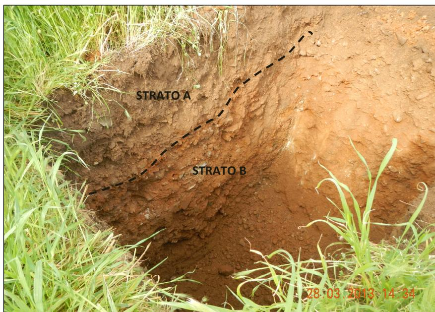
**FIGURA 11** – Suolo dello **Strato A** in **PZ1** a copertura delle alluvioni ghiaiose [**Strato B**].
