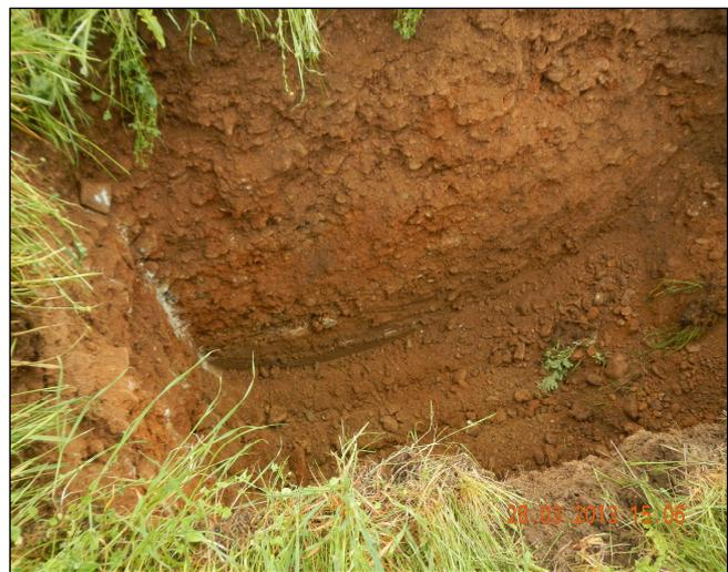
**FOTO 6** - Ghiaie dello **Strato B2** in **PZ4** con lente sabbioso-argillosa sul fondo.
